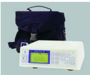
Регистратор показателей качества электроэнергии " РК 3.01" предназначен для измерения и регистрации показателей качества электроэнергии (ПКЭ) в электрических сетях систем электроснабжения общего назначения переменного трехфазного (трех и четырех проводных сетей) и однофазного тока с номинальной частотой 50 Гц. Производит оценку соответствия установленным нормам и выдачу протокола соответствия при измерении в сетях 0,4 КВ непосредственно или относительно вторичного измерительного трансформатора.
